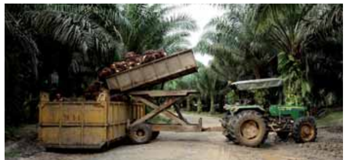
Pengutipan buah tandan menggunakan treler 'scissor lift'
